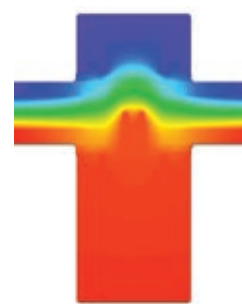
Termisk snit. Mindste varmetab indikeres med rød farve.
