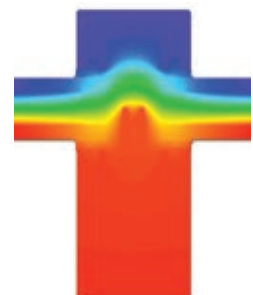
Termisk snit. Mindste varmetab indikeres med rød farve.
