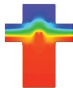
Termisk snit. Mindste varmetab indikeres med rød farve.
